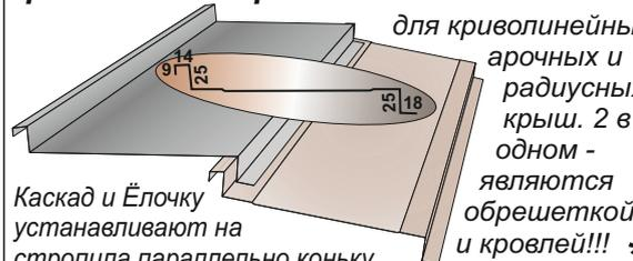
Каскад и Ёлочку устанавливают на стропила параллельно коньку. \* для криволинейных арочных и радиусных крыш. 2 в одном - являются обрешеткой и кровлей!!! \*
